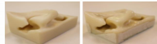
Figura 1. Molde obtido pela impressão 3D (esquerda) e após a suavização (direita)
