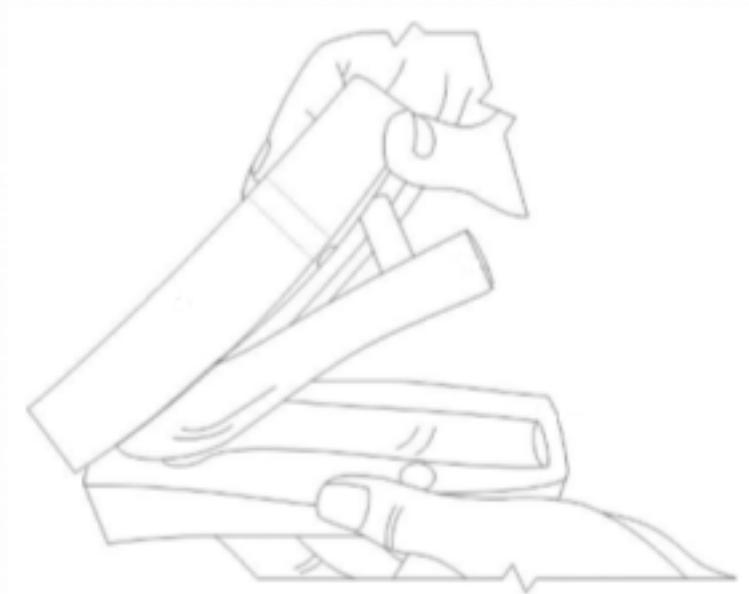
Figura: Representação da retirada da réplica do interior do molde
